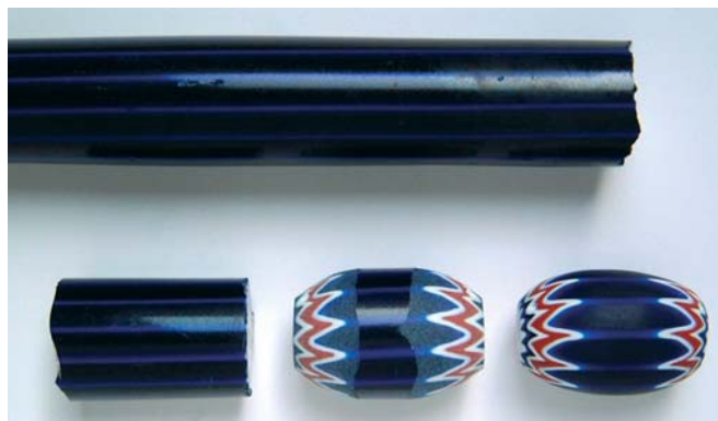
Figura 21 - Fasi di lavorazione di una perla Rosetta.
