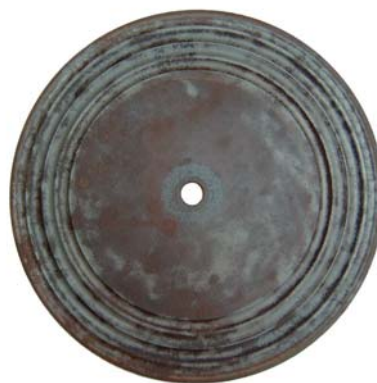
Figura 19 - Disco di ghisa scanalato per la molatura delle perle grosse.
