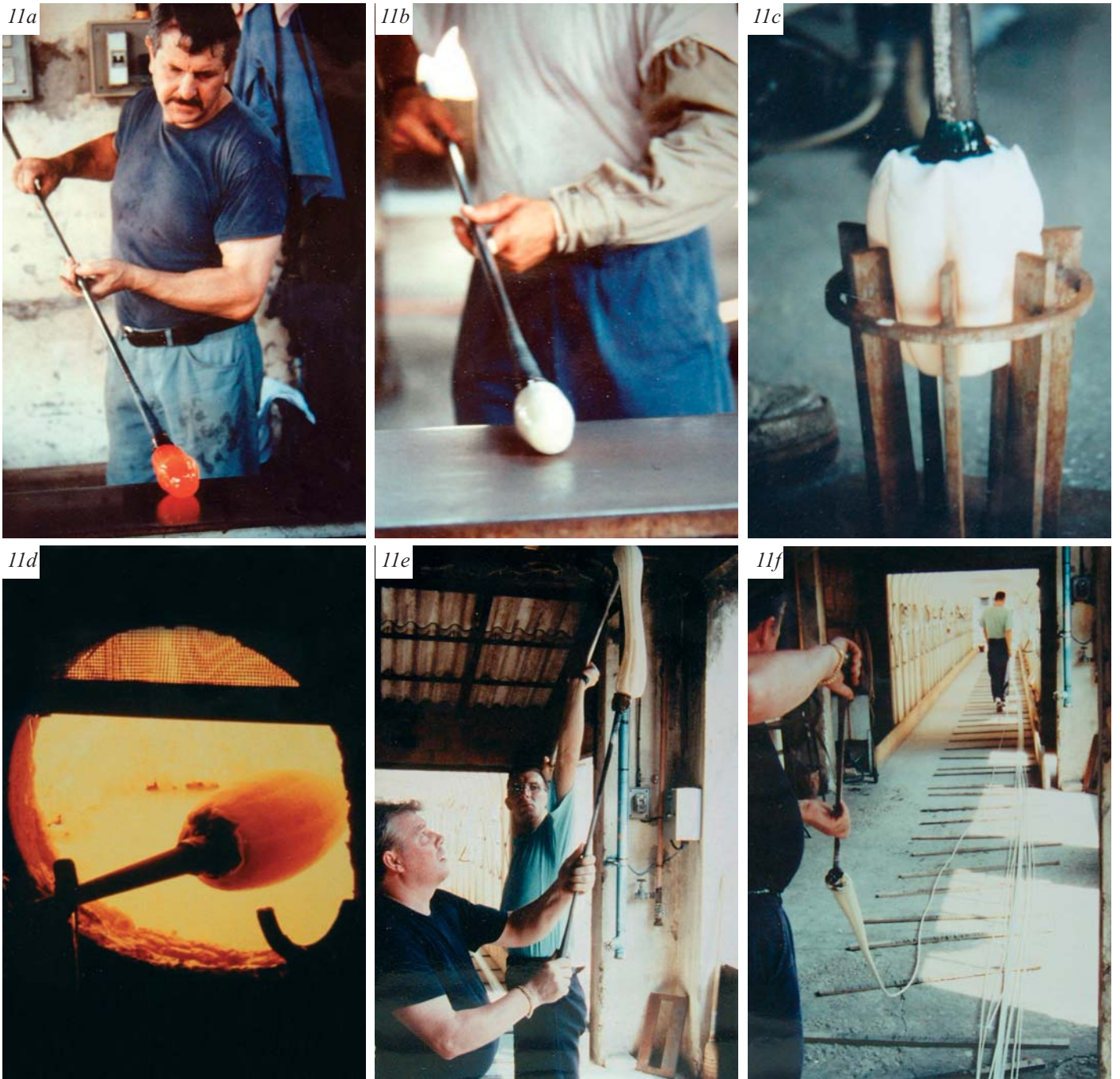
Figure 11a -11b-11c-11d-11e-11f - Fasi di lavorazione di una canna millefiori (Vetreteria Effetre Industriale).
